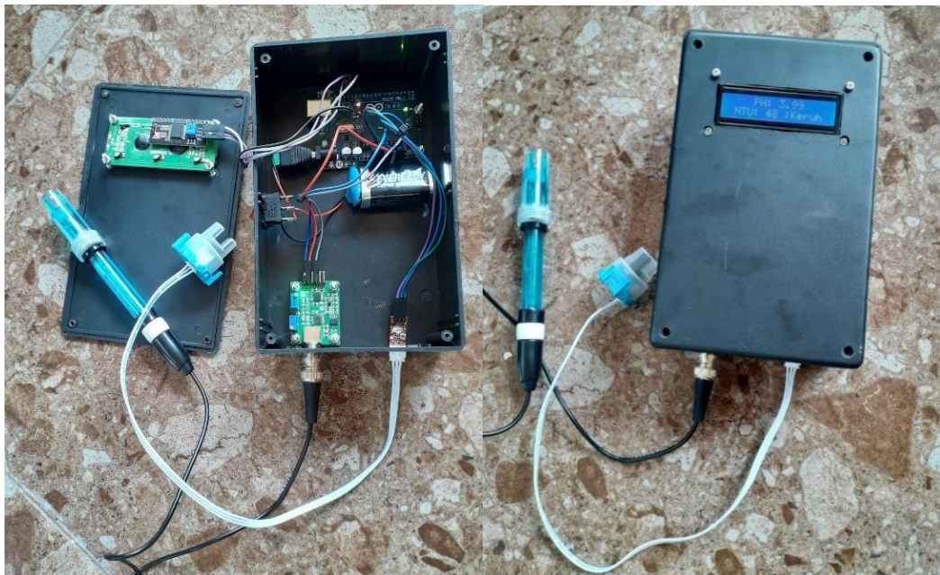
Gambar 6. Tampilan Bagian Dalam dan Luar Alat
