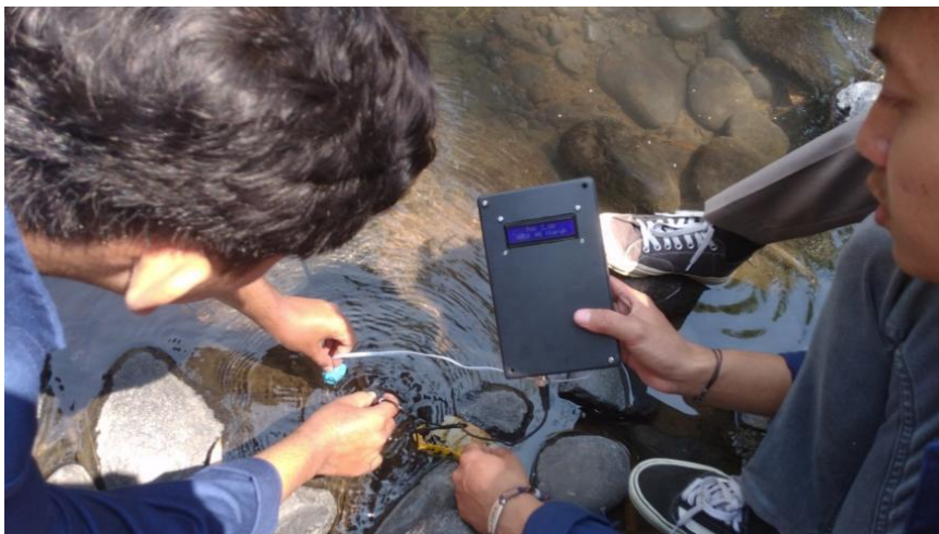
Gambar 5. Alat Sistem Kontrol Pemantau Kelayakan Pakai Air Sungai
