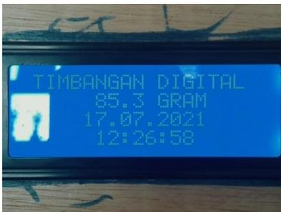
Gbr 13. Tampilan LCD Pada Mesin Drop Box Telur
