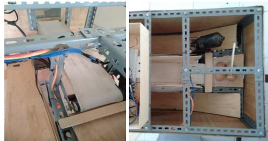
Gbr 12. *Conveyor* Pada Mesin *Drop Box* Telur
