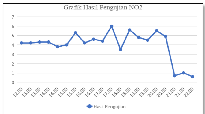
Gambar 20. Grafik hasil pengujian sensor Mic-6814 (NO2)
