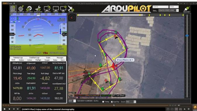
Gambar 26. Uji terbang lintasan angka 8.
