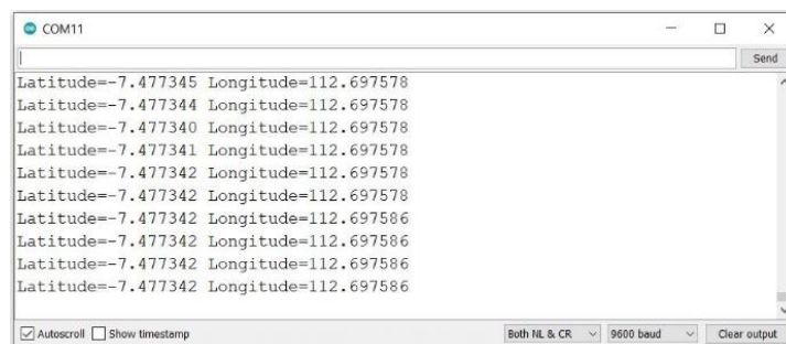
Gambar 16. Hasil pembacaan modul GPS
