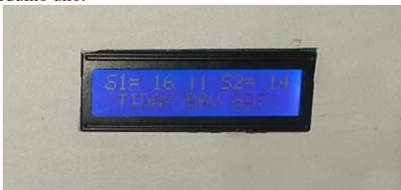
Gambar 7. Hasil pengujian LCD Ketika Tidak Ada Gas
