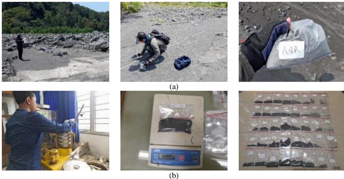
Gambar 4. (a) Kegiatan pengambilan sampel pasir di lapangan dan (b) analisis granulometri laboratorium ukuran butir
