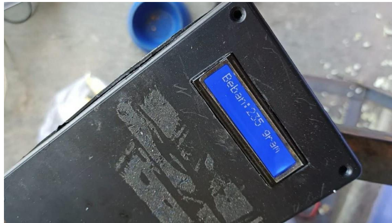
Gambar 9. Pengujian beban yang diperoleh dari loadcell ke lcd
