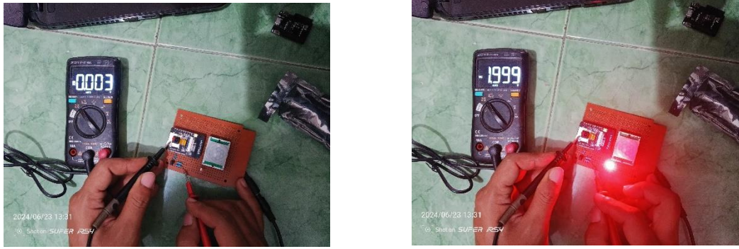
Gambar 15. Pengujian Passive Infrared Receiver dengan Avometer
