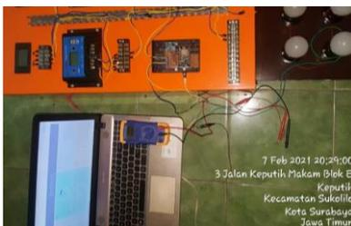
Gambar 4. Kalibrasi Sensor
