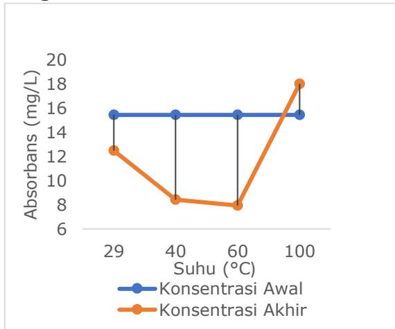
**Gambar 4.** Efektivitas Adsorpsi Variasi Suhu.
