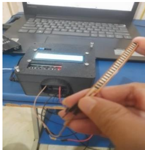
Gambar 2. Setting Flex Sensor dengan arduino Uno
